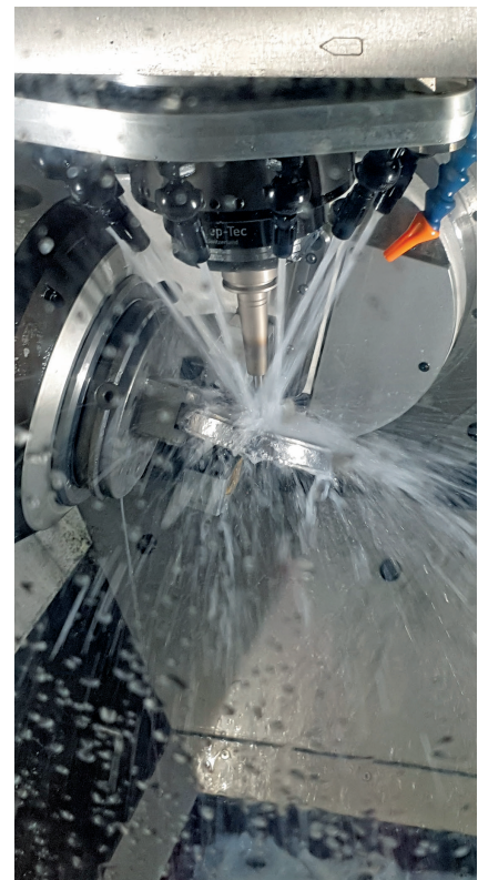
3 Die Mikron HSM 200U LP bei der 5-Achs-Simultanbearbeitung von Zahnprothesen. Diese werden präzise mit sehr guten Oberflächen in einer hohen Bearbeitungsgeschwindigkeit hergestellt
